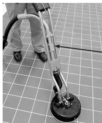
Cubierta del freno de aspiración
